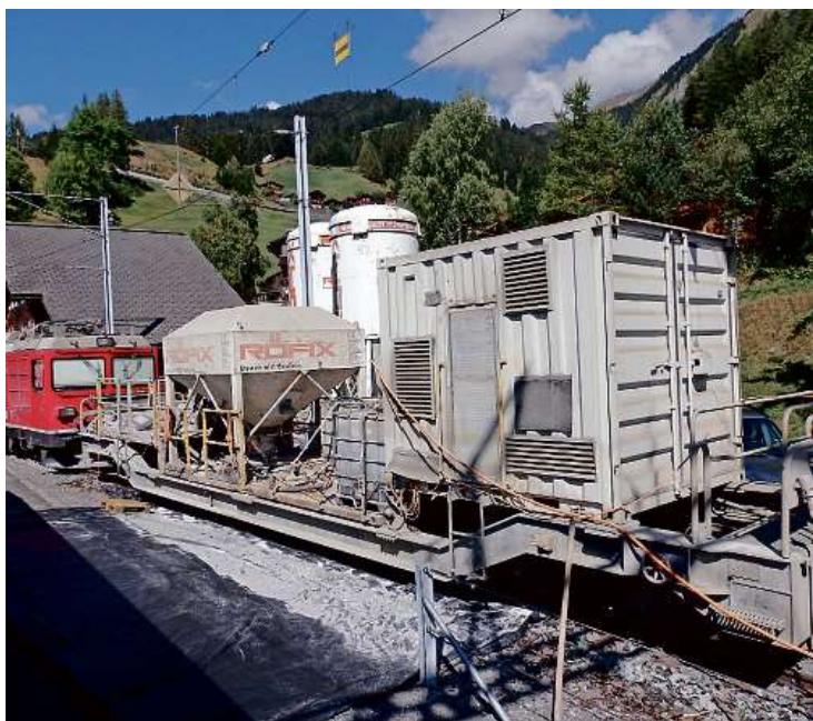
Mit diesem speziellen in Langwies stationierten Bauzug wird nachts Sanierungsmaterial zu den Tunnels transportiert.
